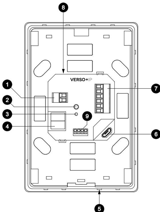
1. Anschluss für Hilfsspannung (12-30 VDC)
